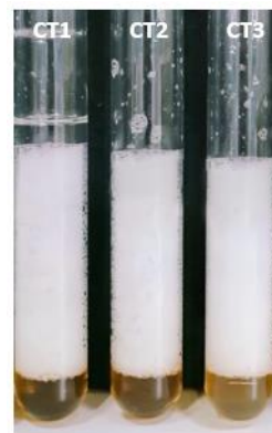
Hình 2. Kết quả thí nghiệm tạo bọt 3 công thức CT1, CT2, CT3
