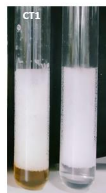
Hình 3. Kết quả thí nghiệm tạo bọt công thức CT1 và nước rửa chén thương mại
